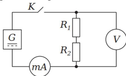
В ходе работы мы исследуем силу тока, напряжение и сопротивление при последовательном соединении проводников, а также определим достоинства и недостатки данного вида соединения.
